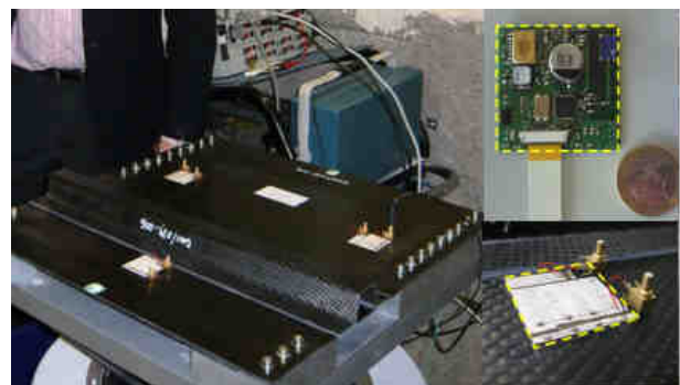
Figure 1 : Structure composite instrumentée de capteurs et d'actuateurs piézoélectriques autoalimentés
